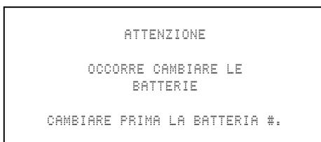
Al posto del simbolo # apparirà il numero 1 o 2 che indica la batteria da sostituire per prima.
