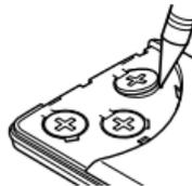
5. Instale a nova pilha com o lado positivo (+) virado para cima.
