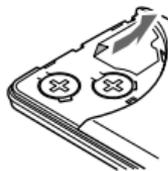
4. Retire a pilha usada com uma caneta esferográfica ou objeto similar.
